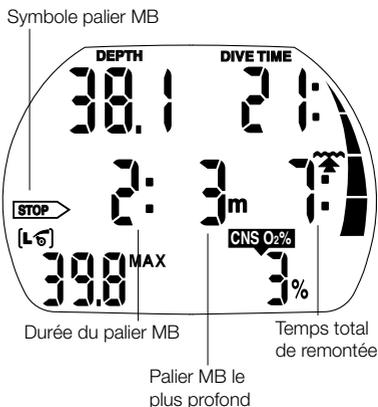
Au début de la phase avec palier MB, NO STOP disparaît, et la flèche LEVEL STOP apparaît. La flèche clignote pendant 8 secondes, et on entend un signal sonore. Pour terminer la plongée sans être ramené à un niveau de MB inférieur, tous les paliers MB prescrits doivent être respectés.
