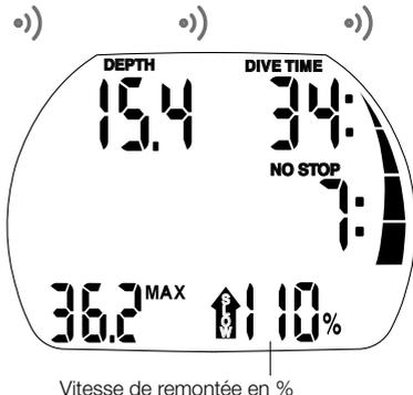
La vitesse optimale de remontée varie entre 7 et 20 mètres/min. selon la profondeur. La vitesse réelle s'affiche en pourcentage de la vitesse préconisée. Quand la vitesse de remontée est supérieure à 100% de la valeur optimale, la flèche noire « SLOW » apparaît. Si la vitesse de remontée atteint 140% et plus, la flèche commence à clignoter. A partir de 110%, un signal sonore se déclenche et son intensité varie en fonction de l'ampleur du dépassement.
